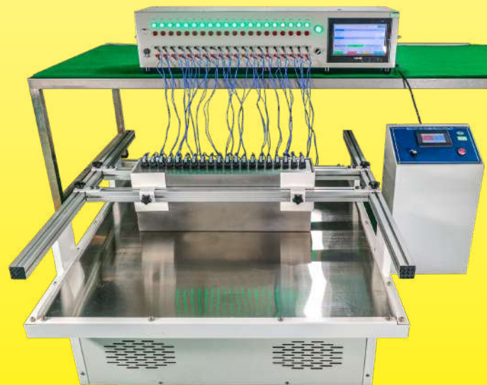
通过模拟运输条件，用于测量空气开关的耐振动性和压力开关的慢动作触点的测试设备（Ultimheat实验室）
